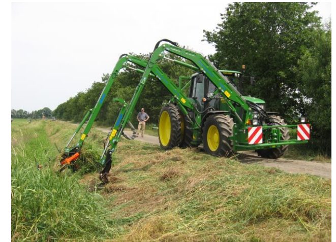
Mäh-, Harkkombination am Schlepper
